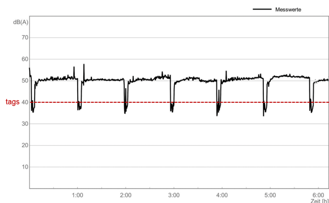
Abbildung 1: Pegel-Zeit-Verlauf, Messung am Immissionsort Freisitz in ca. 4 m Abstand zur Luft/Wasser-Wärmepumpe, rot-gestrichelt: um 10 dB reduzierter Immissionsrichtwert tags für ein reines Wohngebiet.
